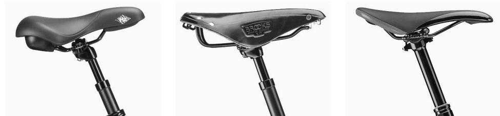
Figura 5. L'impostazione dell'angolo della sella per una Lundi 26 (a sinistra), per uso misto (in mezzo) e per MTB (a destra).
